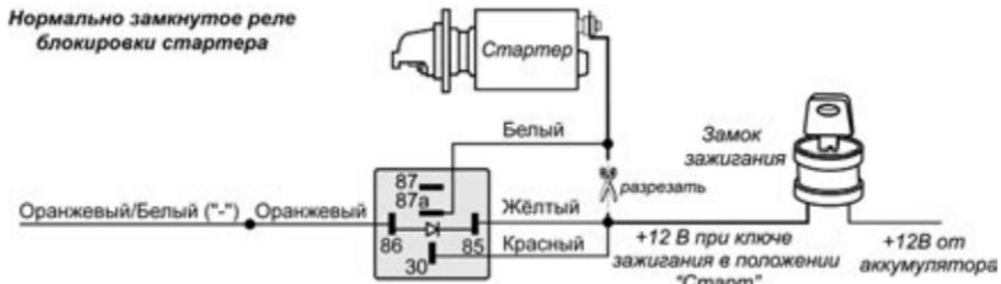
**Примечание.** Для использования нормально замкнутой блокировки измените заводское состояние программируемой функции №16 на "выход для блокировки стартера нормально замкнутым реле".
