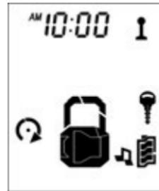
Динамик передатчика с 2-сторонней связью подаст 1 короткий сигнал и/или 1 раз включится встроенный вибратор. На ЖК-дисплее передатчика символ открытого замка сменится символом **закрытого** замка и
