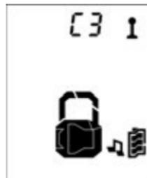
**Примечание:** На время активизации 3-го канала в режиме охраны будут отключены вход датчика и вход зажигания. Если вход датчика системы или вход зажигания остается активным после окончания работы выхода 3-го канала системы – данная зона будет обойдена, сирена системы подаст 3 сигнала, а указатели поворота включатся 3 раза.
