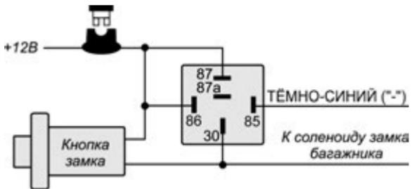
**Внимание!** Подсоединение ТЁМНО-СИНЕГО провода непосредственно к сильноточным цепям замка багажника или к некоторым устройствам дистанционного запуска двигателя приведет к повреждению основного блока системы.
