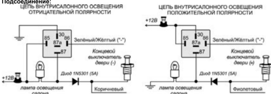
**ВНИМАНИЕ:** Обязательно используйте диод для изолирования цепи управления внутрисалонным освещением от цепи триггера двери. В противном случае не сможет правильно работать функция пассивной постановки на охрану и функция автоматической повторной постановки системы в режим охраны.
